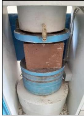
**Gambar 3** Uji Kuat Tekan Beton Geopolimer
