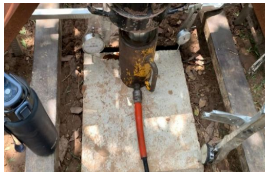
Gambar 7 Uji Pembebanan di Titik D
