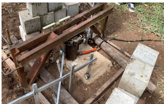
Gambar 6 Uji Pembebanan di Titik C
