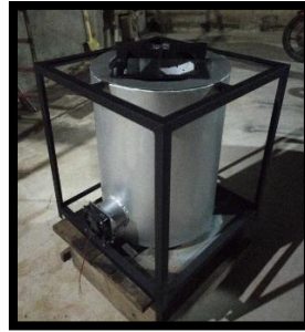
Gambar 7. Kompor Biomassa Menggunakan Bahan Dasar Plat Galvanis Dilengkapi Dengan Teknologi Blower
