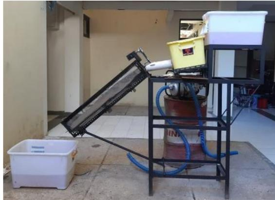
Gambar 11. Hasil Sistem Pembangkit Tenaga Listrik Turbin Archimedes Screw
