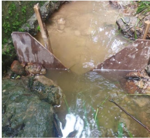
Gambar 2. Pengukuran Debit Menggunakan Metode V-Notch Thompson
