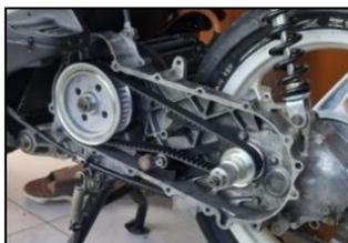
Gambar 4. *Gear Set Pulley* Terpasang Pada Beatrix
