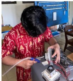
Gambar 4. Pemasangan Modul Termoelektrik
