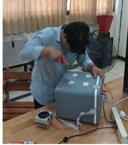
Gambar 3. Membuat Lubang pada Sisi Belakang Box Plastik untuk Pemasangan Modul Termoelektrik
