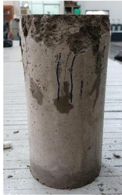
(e) Beton Variasi *Xanthan gum* (BVX) 5%**Gambar 7. Sampel yang telah diuji tekan berumur 7 dan 28 hari**
