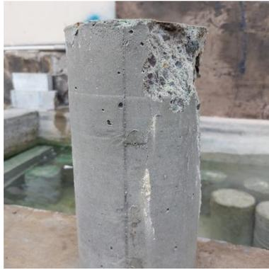
(d) Beton Variasi *Xanthan gum* (BVX) 4%
