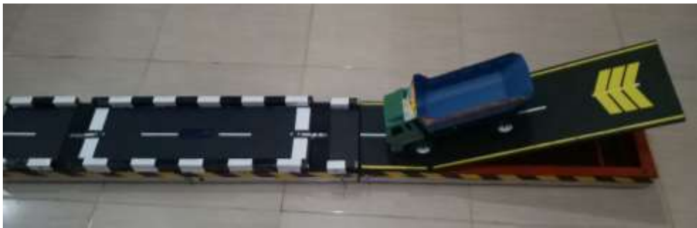
Gambar 4 Kalibrasi sensor terhadap beban bergerak
