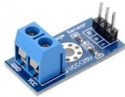
Gambar 7. Sensor Tegangan DC [19]
