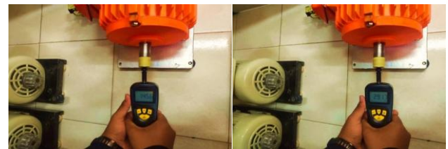
Gambar 3. pengukuran kecepatan rotor motor Dahlander
