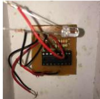
Gambar 6. Bentuk rangkaian pendeteksi tegangan listrik
