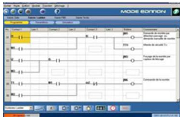
Gambar 15. PLC Zelio dalam bentuk Ledder
