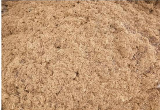
Gambar 7. Serabut (*Fibre*) Kelapa Sawit
