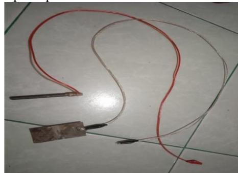
Gambar 1. Model elektroda karbon grafit dan seng
