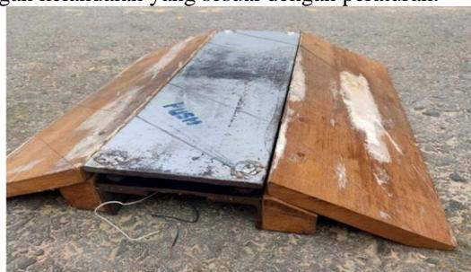
Gambar 8. Kerangka pada *Speedbump* piezoelektrik
