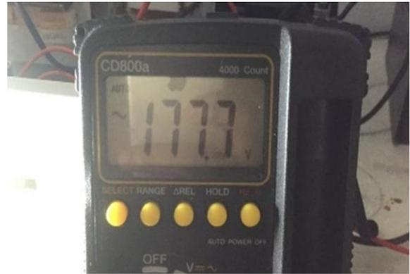
Gambar 11. Tegangan hasil pengujian pemberian beban lampu 8 watt
