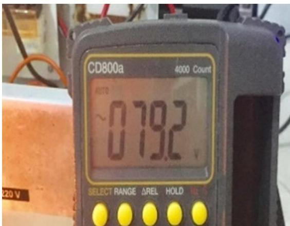
Gambar 13. Tegangan hasil pengujian pemberian beban lampu pijar 60 watt
