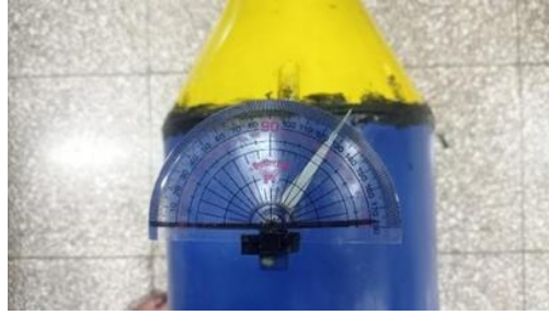
Gambar 7. Kondisi rudder pada posisi 35° derajat simpang kanan
