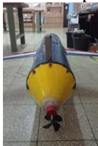
Gambar 4. kondisi rudder pada pengujian sensor gyroscope dengan sudut 30°
