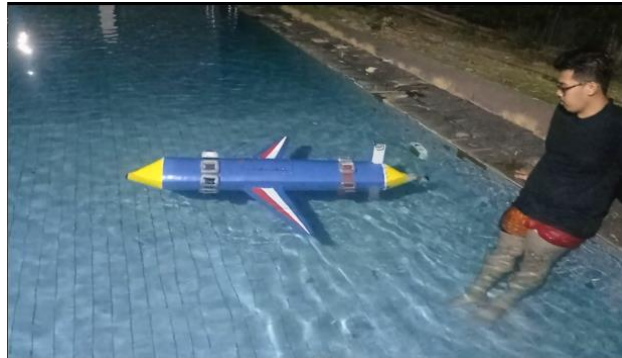
Gambar 12. Pengujian sudut rudder 20° pada saat dikolam
