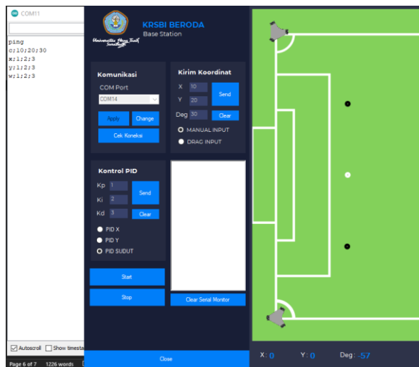
Gambar 10. Hasil pengiriman data dari base station ke robot
