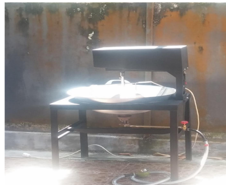
Gambar 6. Mesin Pembuat Sambal Dengan Kapasitas 10 kg
