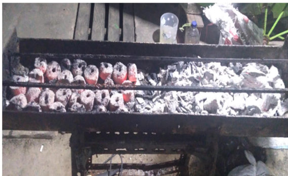
Gambar 2. Hasil bakaran briket tempurung kelapa (kiri) vs arang kayu (kanan)
