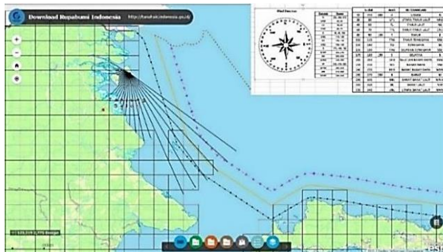
Gambar 5. Fetch Arah Timur, Tenggara, Selatan, Barat Daya, Barat, Barat Laut (Sumber:Hasil Analisa Data Menggunakan AutoCad)
