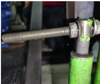
Gambar 17. Kondisi Awal Baut Sebelum Uji Tekan
