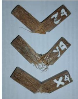
Gambar 10. Bentuk Patahan Spesimen Tanpa Perlakuan Berkomposisi X4 (10%/90%); Y4 (15%/85%); dan Z4 (20%/80%)
