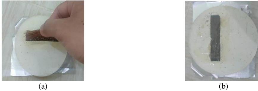
Gambar 5. (a) Pencetakan Serat Kelapa; (b) Cetakan Spesimen
