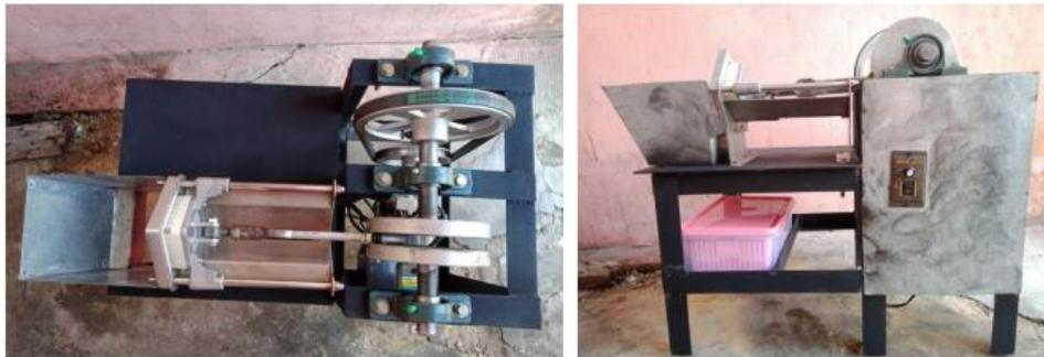
Gambar 3. Hasil Pembuatan Mesin Pemotong Stik Kentang Skala Rumah Tangga
