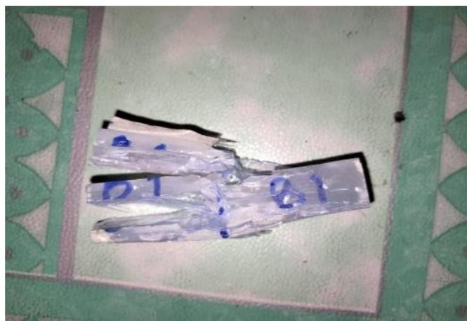
Gambar 5. Bentuk Patahan Material Komposit Spesimen B
