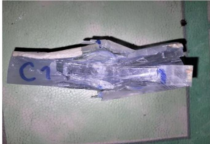
Gambar 6. Bentuk Patahan Material Komposit Spesimen C
