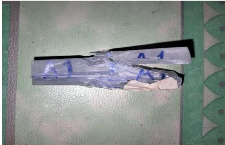
Gambar 4. Bentuk Patahan Material Komposit Spesimen A
