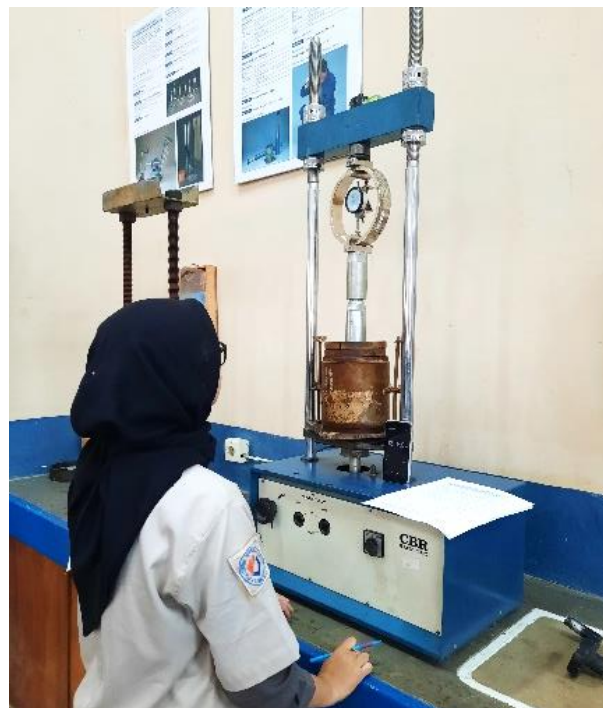
Gambar 6. Pengujian CBR Laboratorium
