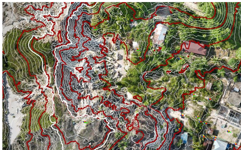
Gambar 4. Bentuk kontur lahan berdasarkan data DTM hasil pengolahan foto udara.
