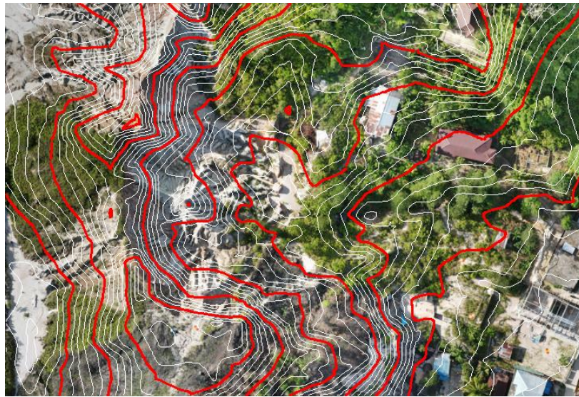
Gambar 3. Bentuk Kontur lahan hasil simulasi pengukuran metode terestrial
