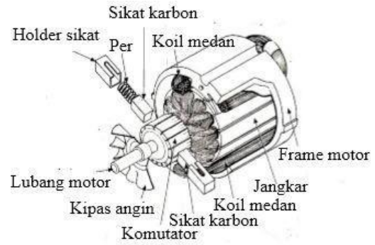
Gambar 2. Konstruksi Motor Universal
