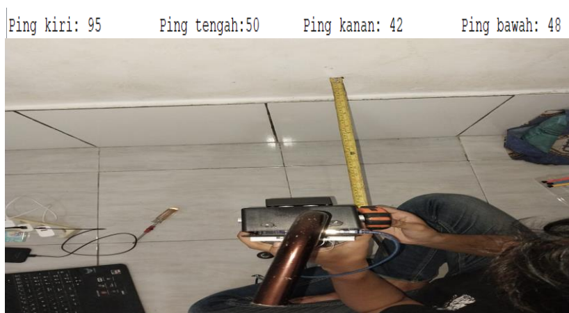
Gambar 12. Pengujian sensor bagian depan pada jarak 50 cm beserta serial monitor
