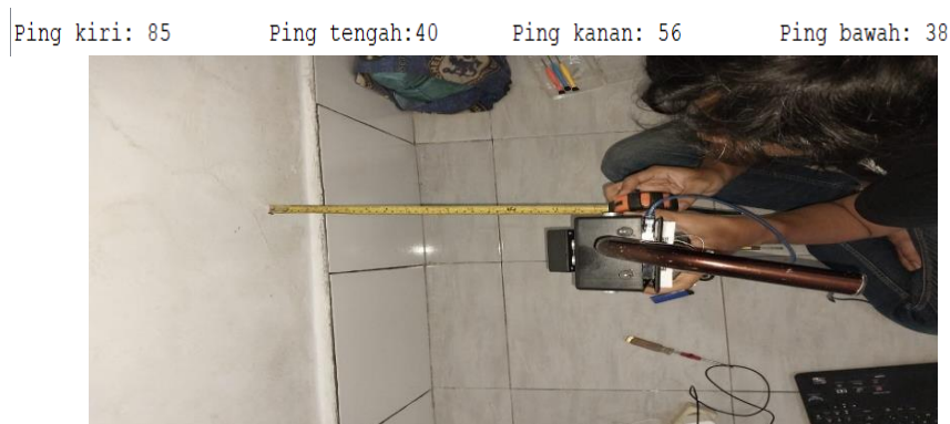
Gambar 11. Pengujian sensor bagian depan pada jarak 40 cm beserta serial monitor
